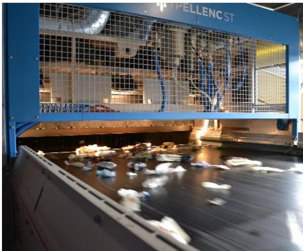
Trieur optique : séparation des matières en fonction de la forme et de la densité
